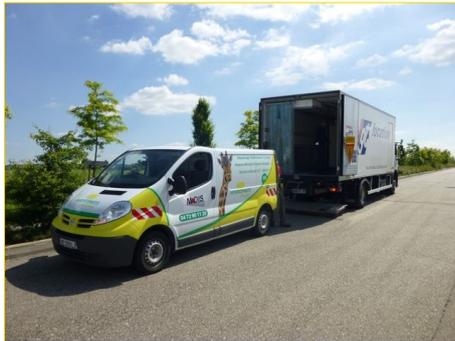
Le hayon élévateur est un équipement de manutention, généralement situé à l'arrière des véhicules. Il est utilisé pour charger et décharger tous types de marchandises, sans difficulté, grâce à un matériel fiable, entretenu et satisfaisant à la législation en vigueur.
